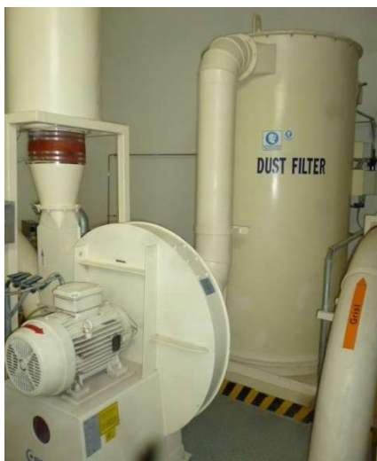
Hệ thống hút bụi tải bột malt từ máy nghiền đến bồn chứa bột malt
