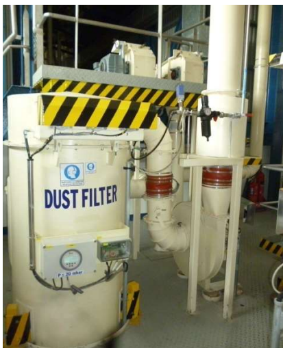
Hệ thống tách bụi bằng tải malt từ silo đến máy nghiền
